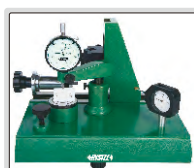
controllare la ripetibilità dei comparatori
